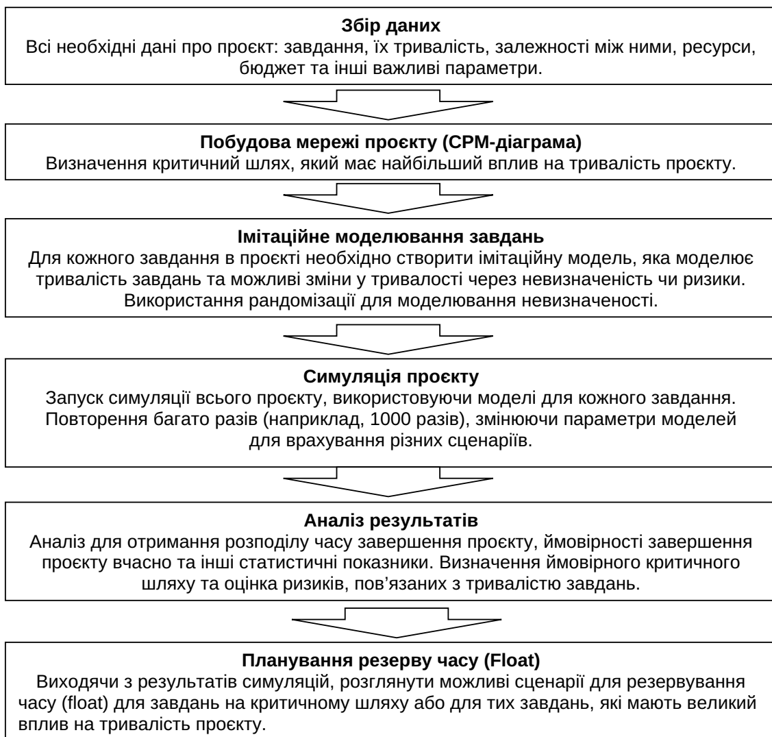
Рис. 3. Алгоритм застосування імітаційного моделювання в методології критичного шляху (CPM)
